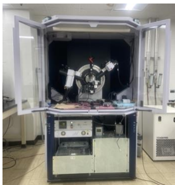
Fig. 3.1 – Bruker D8 Discover XRD instrument.
