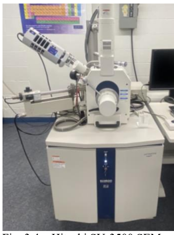
Fig. 3.4 – Hitachi SU-3500 SEM instrument.
